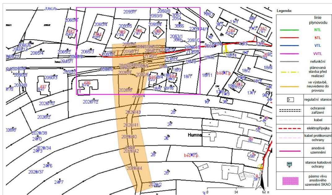
Obrázek 4: Schéma napojení na stávající plynovod na MK Řetečovská, zdroj: GasNet, s.r.o.
